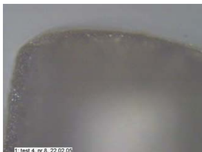
Qualifiziertes Material ohne Whiskerbildung nach Klimatests
